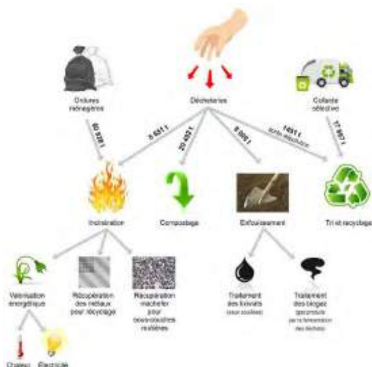
Synoptique des flux de déchets traités par le SMITOM (source : SMITOM Haguenau-Saverne)
