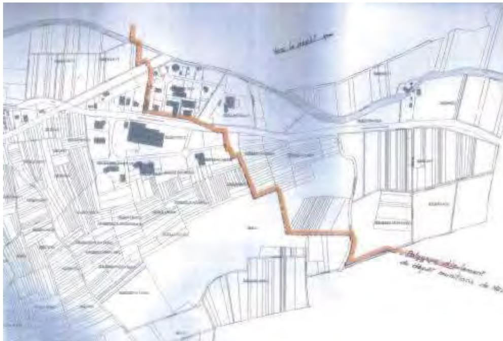
*Illustration 60 : Limites du polygone d'isolement autour du dépôt de munitions de Neubourg*
