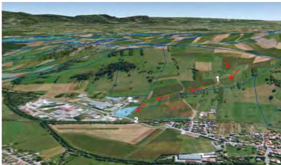
La zone d'activités du Val de Moder connaît des désordres hydrauliques provoqués par les écoulements issus des versants amont. Les écoulements prennent naissance et se concentrent au sein des seuls talwegs secs cultivés du versant (lieu-dit Wiedy). Les écoulements suivent alors la topographie et s'accélèrent dans la pente. Ils arrivent au niveau d'un petit fossé longeant la zone d'activité qui sature rapidement. Les flux boueux débordent et inondent une entreprise.
